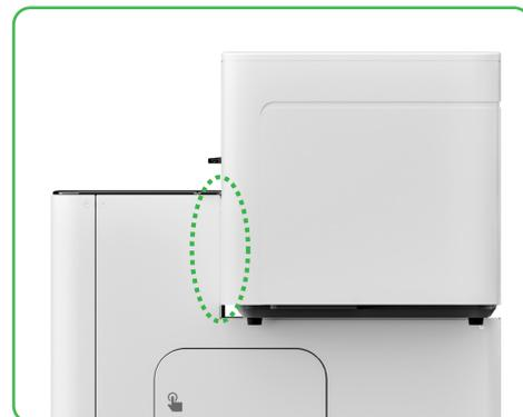
Alinee la ranura de emisión de la impresora con la ranura de conexión de la xTool OS1 y conéctelas.
